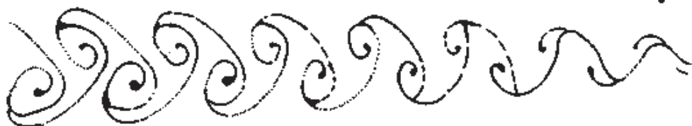
图9 液体流过一细金属丝，产生了如图所示的精巧的涡流，很象是木星表面的花纹（图是根据大卫·特里顿博士的准许复制的）。
