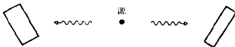
图6 贝尔定理应用于从一个公共源发出的两个反向光子。对各光子分开实行偏振测量，贝尔定理预示这种测量的种种结果之间所允许的相关度存在一个极限。
